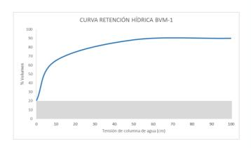
El **sustrato BVM-1** es un SUSTRATO DE CULTIVO DE MEZCLA, orgánico, obtenido a base de mantillo vegetal y gravas volcánicas. Este producto permite la implantación de una cubierta aiardinada en régimen ecológicas semi-EXTENSIVO, o cubiertas extensivas o en algunas circunstancias en intensivas, en cultivo de especies vegetales de necesidades de riego: planta mediterráneo de porte bajo, tapizantes, y especies adaptadas para Xerojardinería.
