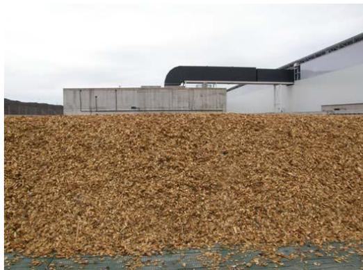
El rendimiento y la vida útil del biofiltro, está en función del tipo de contaminante y de su carga másica, aunque **BURÉS PROFESIONAL, S.A.**, recomienda como tiempo de uso fiable del material de relleno, entre 3-5 años dependiendo de las condiciones ambientales. Tras este periodo el material usado puede ser simplemente compostado sin ningún tratamiento especial.
